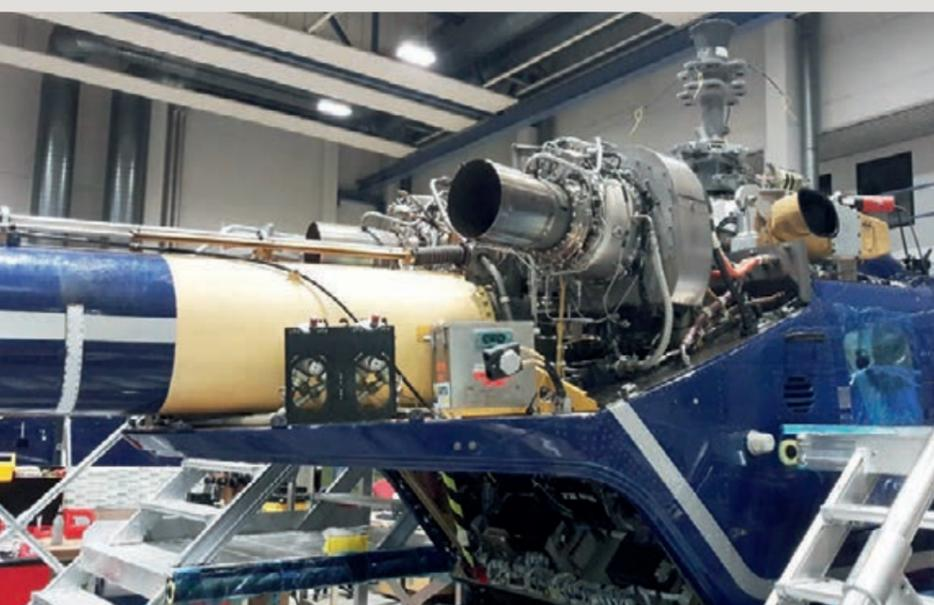
Abb.1 EC 135 mit freigelegtem Triebwerk
