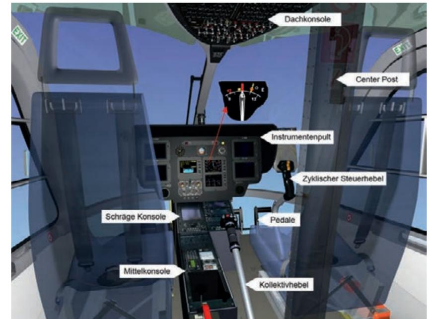
Abb.6 Cockpit, Steuerorgane und Schnitt der Limitanzeige (Torque) des First Limit Indicators (FLI)
