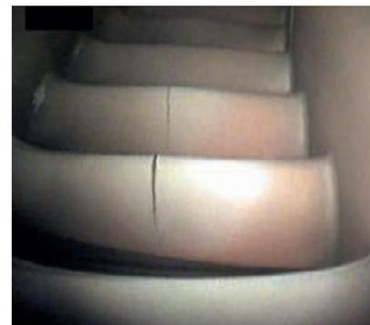
Abb.2 Risse in den LPT1 Nozzle Guide Vanes
