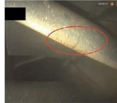
Abb.3 Riss in einem HPT Blade einer PW127M
