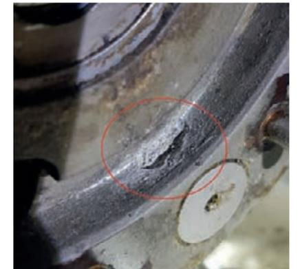
Abb.5 Korrosionsschaden im RGB Rear Cover einer PW121
