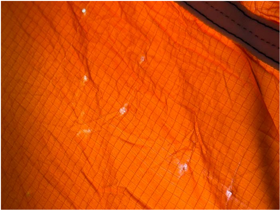
Löcher in Fallschirmkappe
