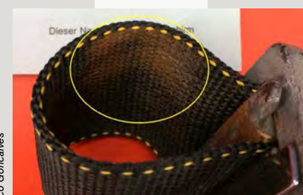
Starke Korrosion am Beingurt und am Beingurt-Beschlagteil V-Ring (Clip+Feder)!
