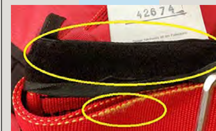
Die Haupttraggurte sind durch ein fehlerhaftes Einlegen des Klettverschlusses sichtbar beschädigt.
