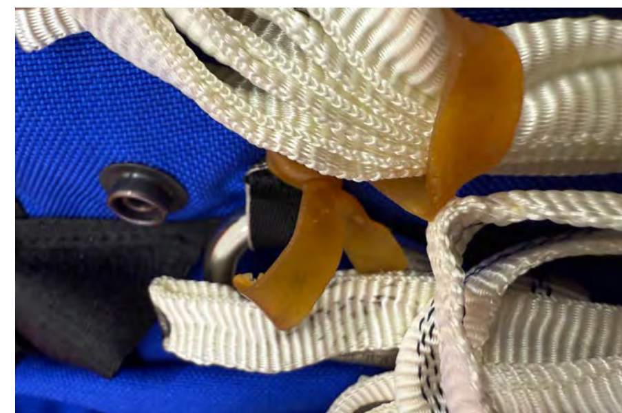
Gebrochene und verklebte Packgummis
