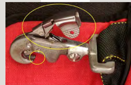
Beingurt-Beschlagteil Auswerferkarabiner (Schnellauslöser) ohne Funktion (Federbruch)
