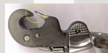
Beingurt-Beschlagteil Auswerferkarabiner ist beschädigt. Schließt nicht! Nase Defekt!
