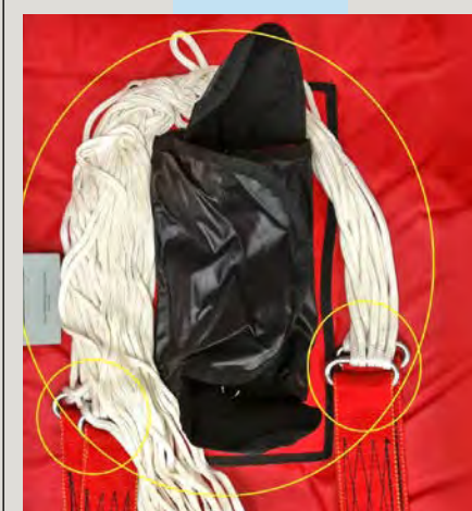
Die Haupttraggurte sind fehlerhaft an den Fangleinenverbindungsstücke eingebaut. Die Tragelast ist um mind. 50% reduziert!
