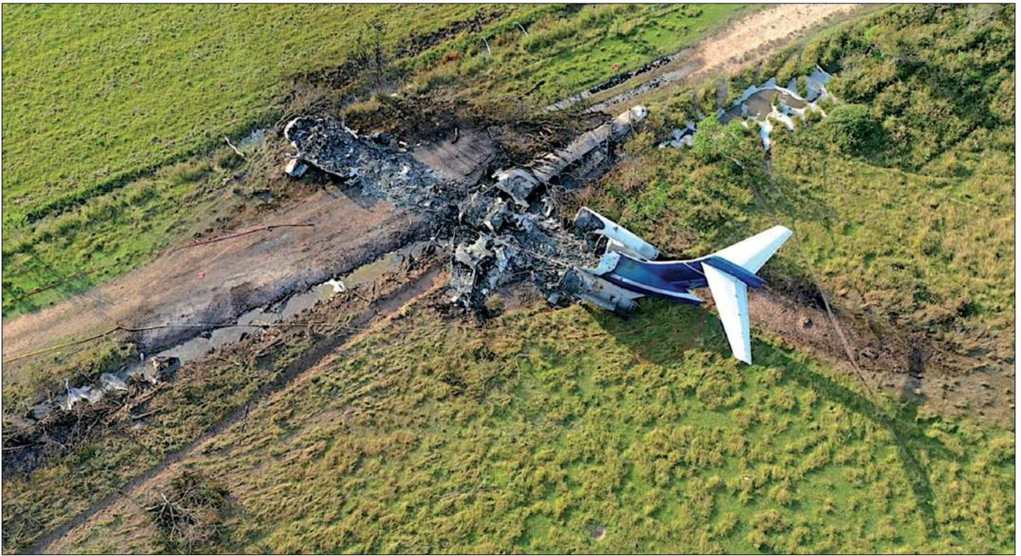
Abb. 2: Nach dem missglückten Startabbruch wurde der vordere Teil der MD-87 durch den ausgebrochenen Brand vollständig zerstört (Foto: NTSB)
