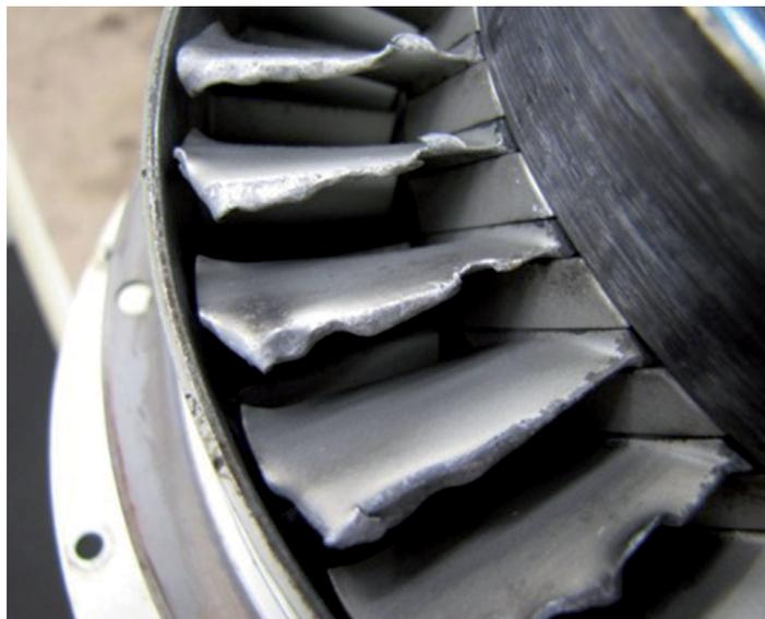
Abb. 5: Pilatus PC-12 Folgeschaden am Rotor der 2. Kompressor-Stufe © Foto Kabamba Aerospace GmbH
