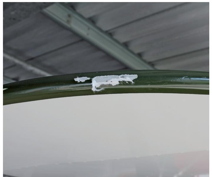
Abb. 2: Rechter Randbogen – Bespannstoff ist durchgescheuert Foto: CDB
