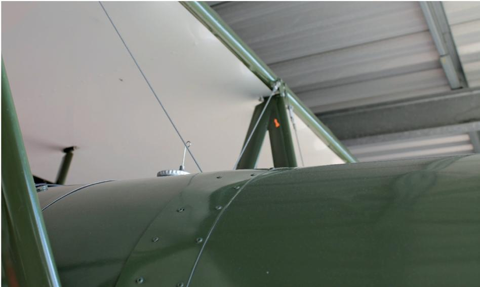
Abb. 4: Beide Risse sind in Richtung rechter Randbogen entstanden. Das erhärtet die Vermutung, dass durch den Hebelarm Randbogen-> Streben (ca. 3,8 – 4,4 Meter) erhebliche Torsionskräfte gewirkt haben. Foto: CDB
