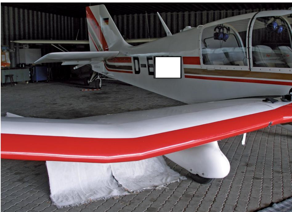
Abb. 5: Beispiel einer fehlerhaft gefertigten Neubespannung nach der HOLM-LTA an einer DR 400. Der Pilot (Testpilot von Airbus und Fluglehrer konnte das Flugzeug dennoch sicher landen) Foto: CDB
