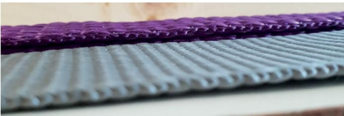
Abb. 4: Ein Hebebänder EN 1492-1 (hinten) und ein Einweg-Hebebänder DIN 60005. Der Unterschied liegt bei 1 zu 3 mm
