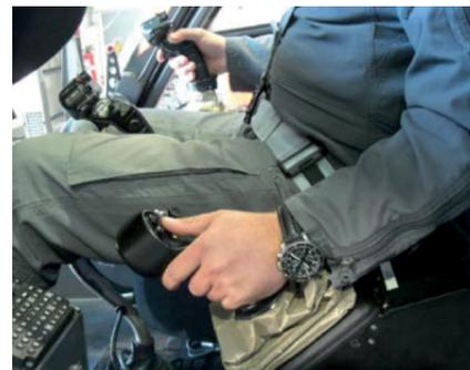
Abb. 3: Pitch (mechanischer Hebel liegt unter der Hand des Piloten).
