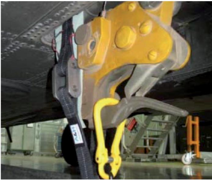
Abb. 9: Lasthakensystem CH-53 (mit Funktionsmuster einer Redundanz)
