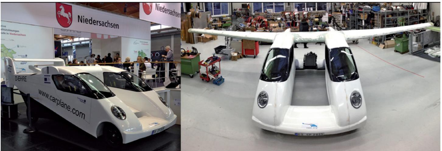
Abb. 3: Der Carplane®, links in Fahrmodus (AERO 2015), rechts in Flugmodus (Werkstatt 2018)
