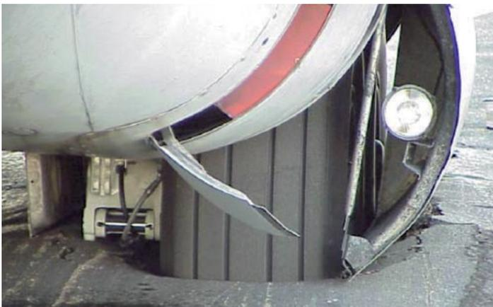
Abb. 1: Versagen einer Flugbetriebsfläche (Trahmer 2004)
