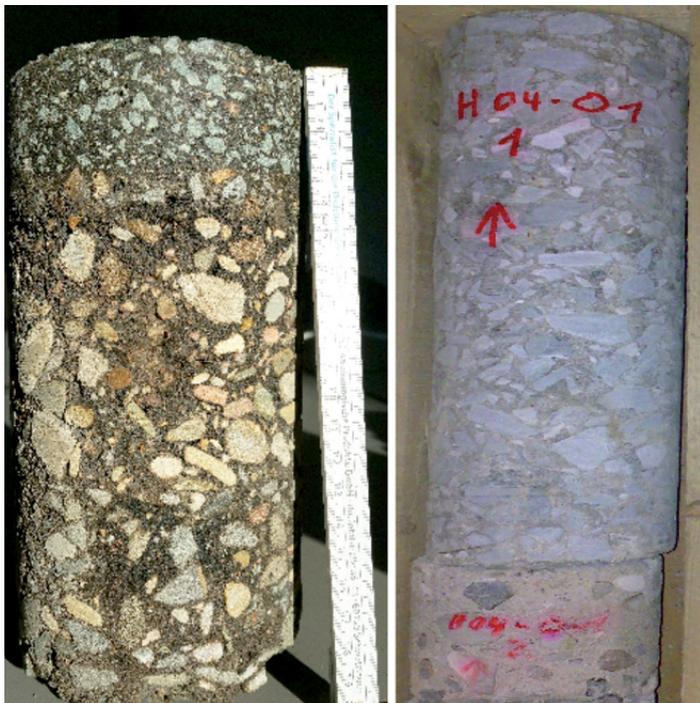
Abb. 8: Bohrkern- Asphaltpiste links
