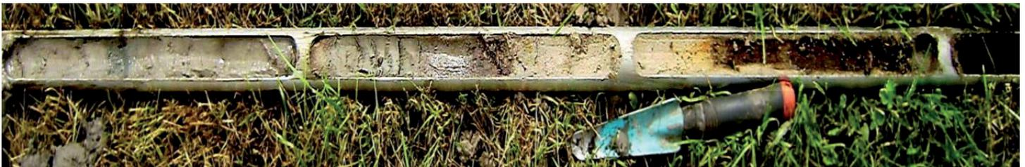
Abb. 14: Bodenaufbau unter einer Graspiste
