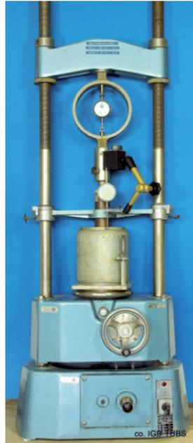
Abb. 4: CBR Versuch im Labor
