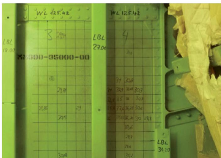
Abb. 5: Hitzeschaden Druckschott Quelle: Gerald Weidenbrück
