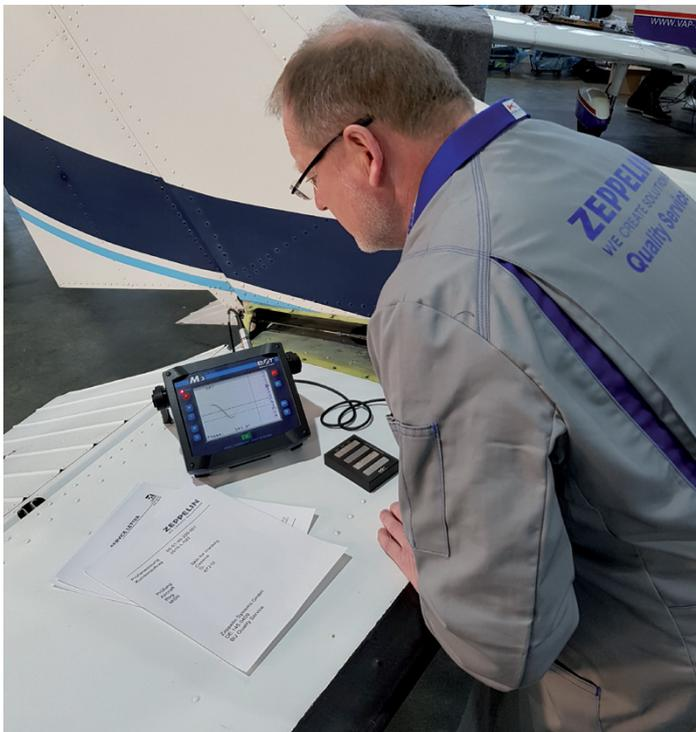
Abb. 1: Wirbelstromkontrolle Anschluss Seitenleitwerk Quelle: Zeppelin Systems GmbH
