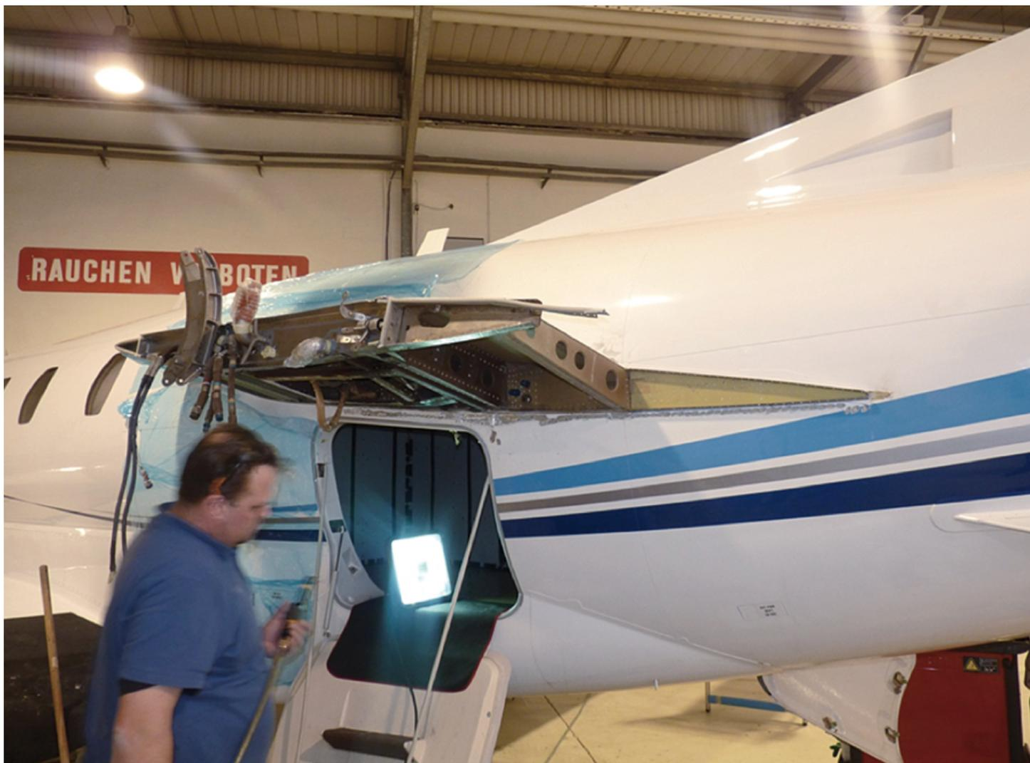
Abb. 1: Linkes Triebwerk zur Reparatur abgebaut
