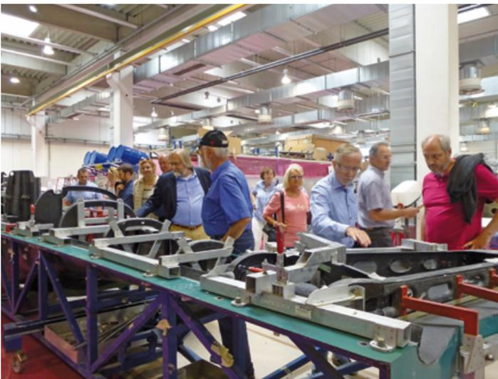
Abb. 4 verklebte Bauteile in den Schablonen Foto R. Taxis
