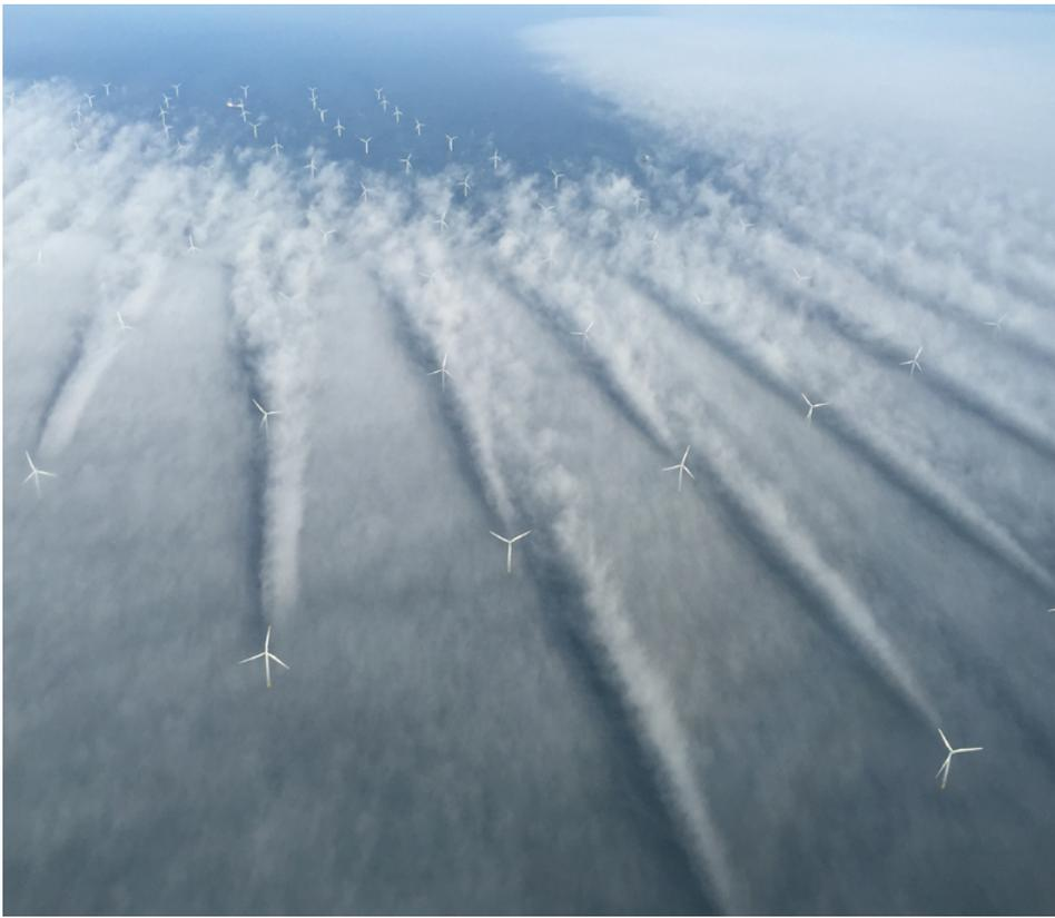
Abb. 2: Kondensierte Luftströmung in Nabenhöhe signalisiert den turbulenten Nachlauf der Windkraftanlagen. Fotograf: Bel Air Aviation
