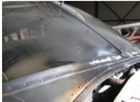
Abb 2: Frontscheiben mit dahinterliegender Verkabelung und Avionik zerstört.
