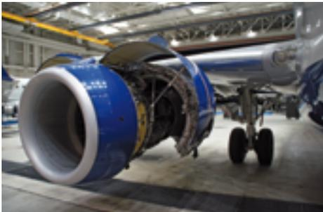
Abb 1: Rechtes Triebwerk CF34-8E
