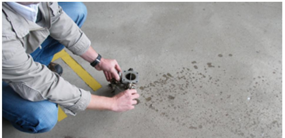
Abb 3: Ortstermin Vergaserbrand an einer Cessna 172 (LG Münster) – Demonstration „Pumpen mit dem Leistungshebel“
