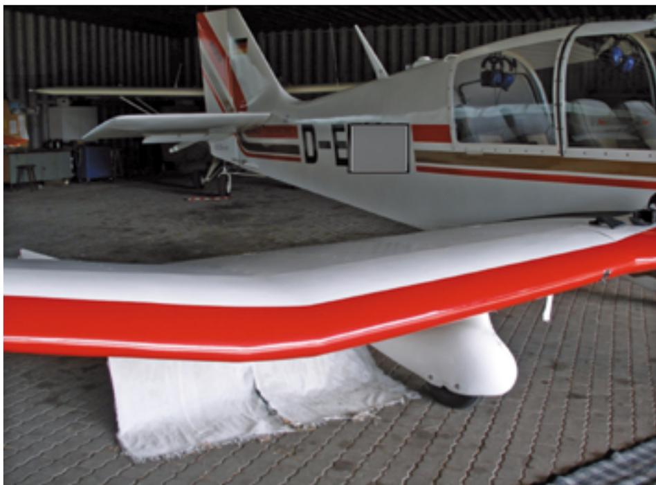
Abb 1: Abgelöste Flügelbespannung DR 400
