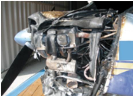
Abb 1: Völlig zerstörter Motorbereich
