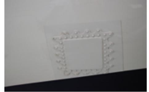
Abb 2: Doubler Repair am vorderen Rumpf Segment
