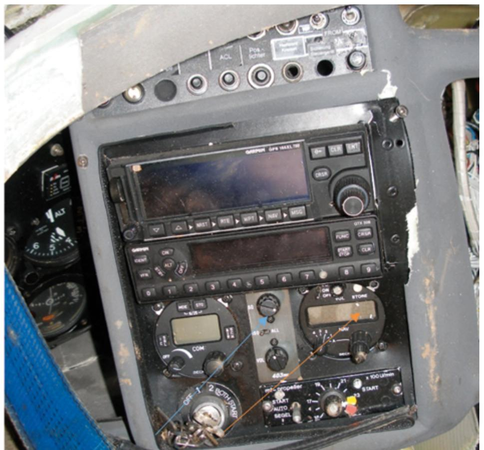
Abb. 2: Zündschalter (AUS) Propellerbedienung (Segelstellung) Foto: C.D.Bäumer
