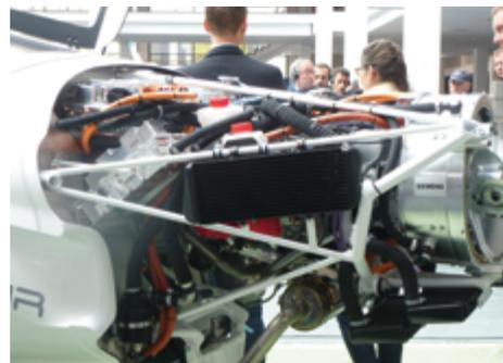
Abb 4: Hypstair Kombination Siemens Elektro- und Verbrennermotor (Foto R.Taxis)
