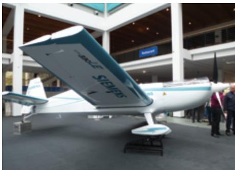
Abb 2b: Extra 330 mit Siemens E-Flugmotor (Foto R.Taxis.)
