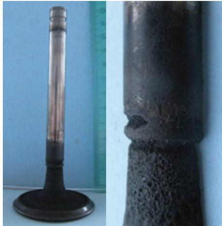
Abb 1: (a) Schadbauteil im ausgebauten Zustand, (b) Kritischer Oberflächenzustand im Übergangsbereich zum Schaft (rechts)
