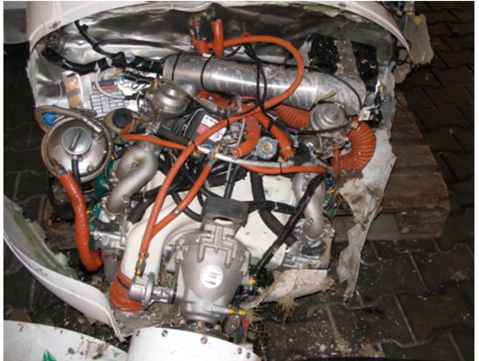
Abb. 1: Triebwerk – Propeller in Segelstellung Foto: C.D.Bäumer
