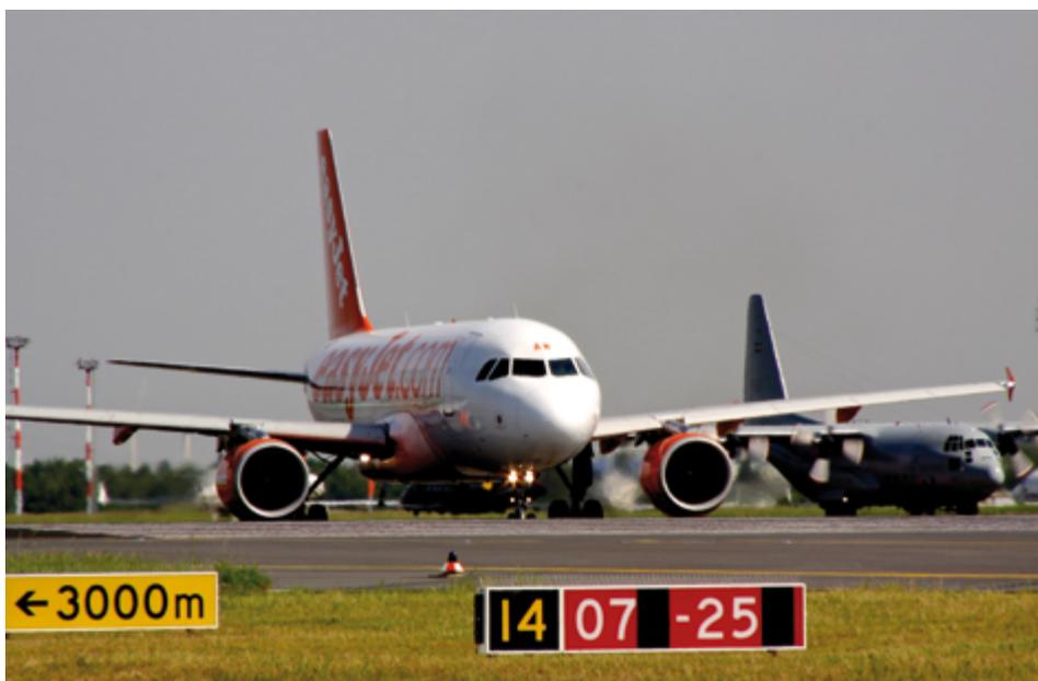
Abb. 2. Die Halteschilder am Rollhalt sind in rot gehalten. Über sie hinaus darf – wie dieser Airbus von EasyJet – nur mit einer Freigabe gerollt werden (Foto: Werner Fischbach)
