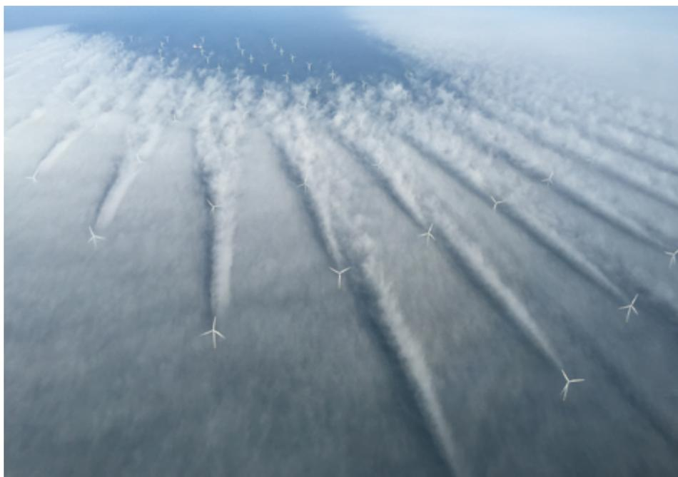
Abb. 1: Horns Rev2 ñ Nachlauf turbulenten am Offshore Windpark (Foto Bel Air Aviation Helicopter Denmark)
