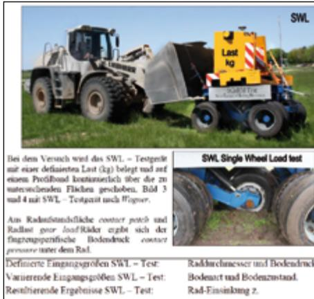
Bei dem Versuch wird das SWL – Testgerät mit einer definierten Last (kg) belegt und auf einem Profilband kontinuierlich über die zu untersuchenden Flächen geschoben. Bild 3 und 4 mit SWL – Testgerät nach Flieger.
