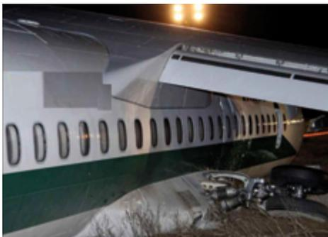
Ist die Einsinkung zu groß kommt es zum sog. collaps, das Rad / Fahrwerk bricht, ein
