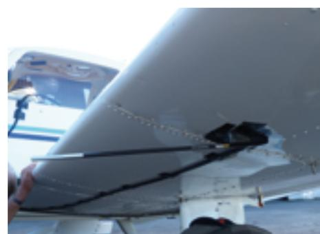
Abb 5: zusätzliche Pilot-Messsonde
