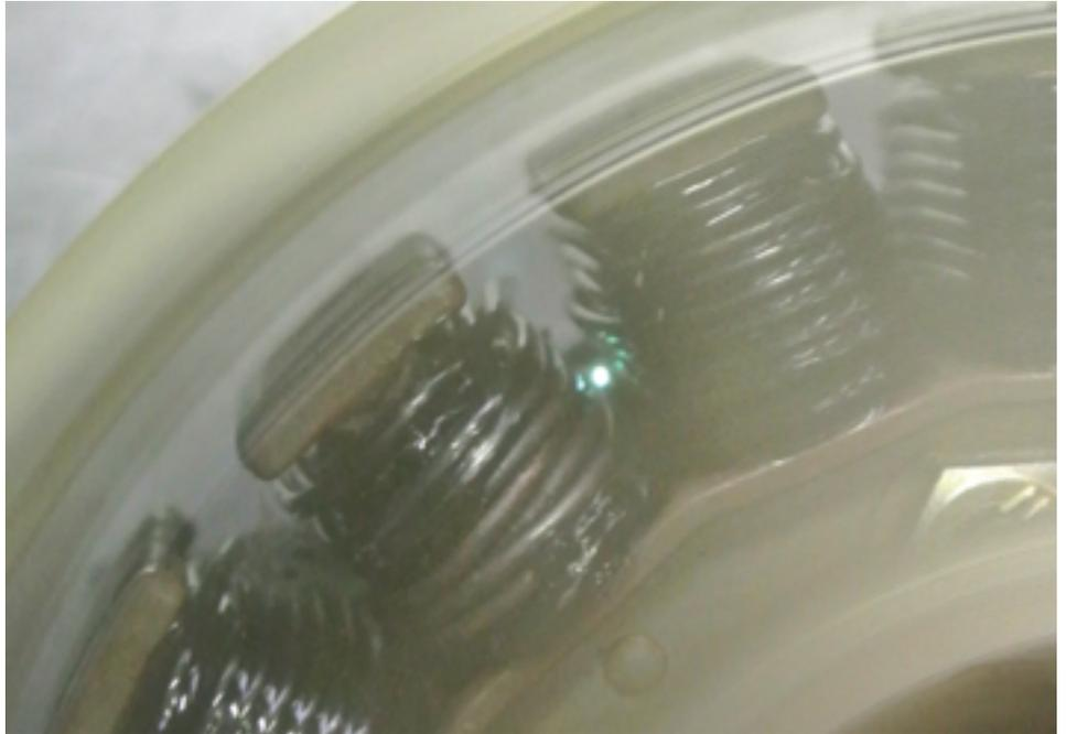
Abb. 1: Beschädigte Isolierung einer Wicklung und Spannungsüberschlag
