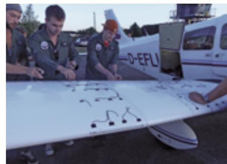
Abb 4: Anbringen von Wollfäden zum Demonstrieren der lokalen Tragflächenströmung
