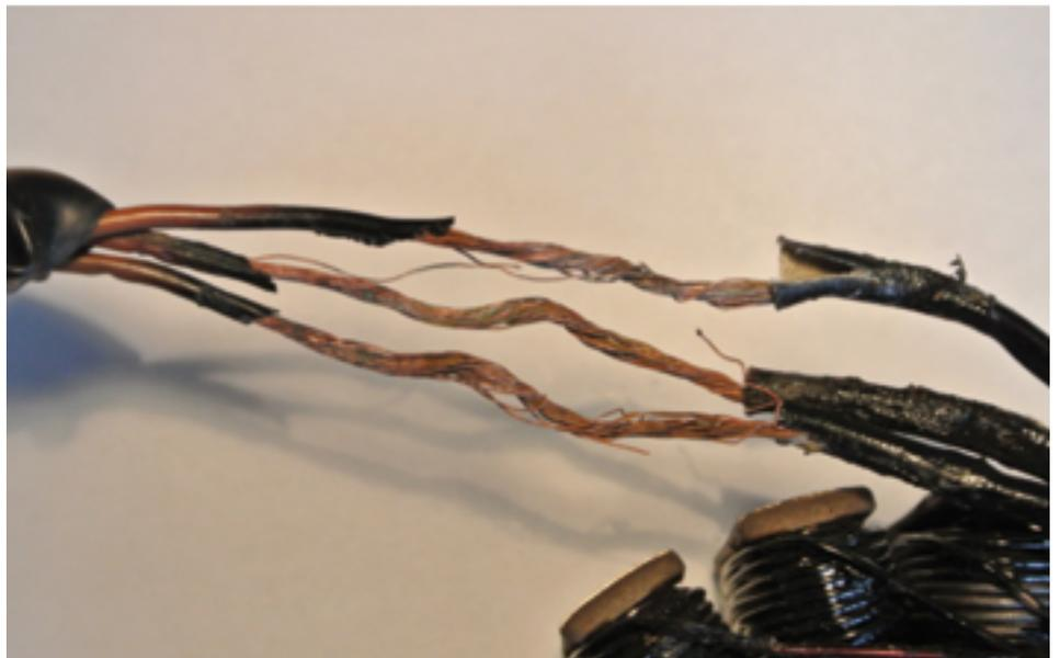
Abb. 2: Beschädigte Isolierung der Anschlusskabel nach Freilegung
