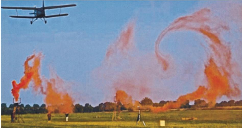
Abb. 2: Visualisierung der AN-2-Wirbelschleppen bei den Versuchen in Reinsdorf (Foto: BFU/DLR)
