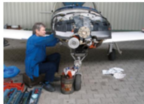
Abb.1: Ortsbesichtigung 1 nach Besichtigung: Abbau des Triebwerkes
