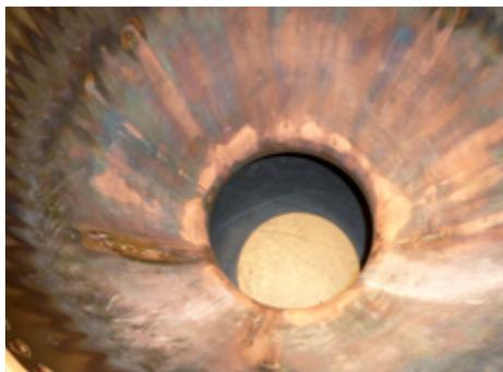
Abb 13b: sichtbare thermische Verfärbung in der Vulcain Brennkammer nach mehreren Testläufen
