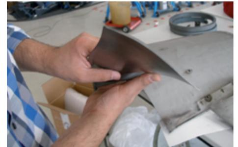
Abb.1: Durch Vogelschlag beschädigte Fanschaufel
