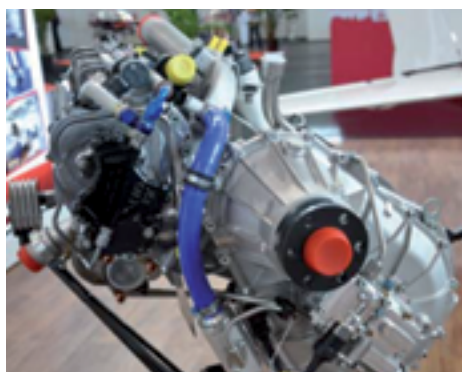
Abb 1: Von Aussen sieht man dem bekannten CD-155 von Continental Motors die Menge an Arbeit, die in die Vergrößerung der TBO nicht an. (Foto: Andrea Wanner)
