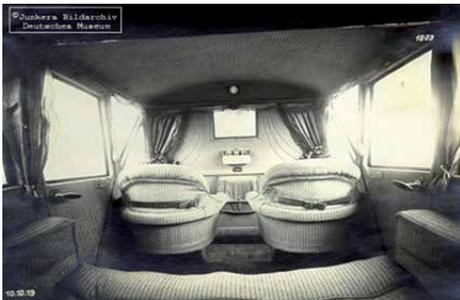
Abb. 3: Kabine der ersten Junkers F13 aus dem Jahr 1919
