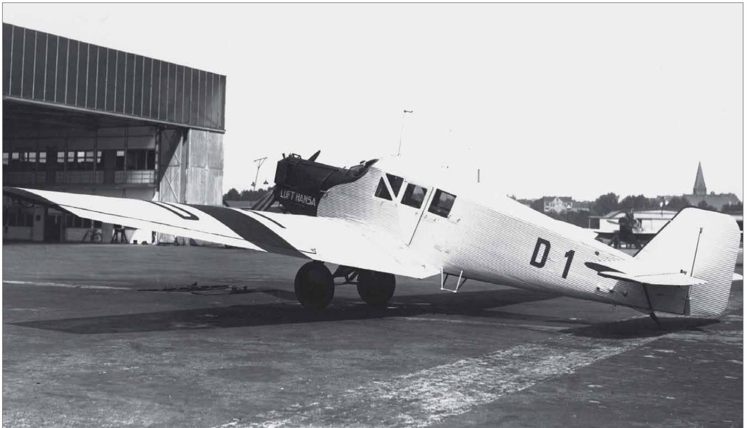
Abb. 1: Junkers F13 mit dem Anfang der zwanziger Jahre geänderten Seitenleitwerk
