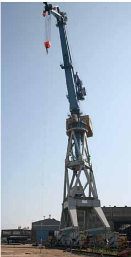
Vertikaler Versuchsaufbau zur Beurteilung des Hochschlagverhaltens auf dem Gelände der Blohm + Voss Werft in Hamburg. Damit wurden Lastenseile bis zu einer Länge von 40 m getestet.
