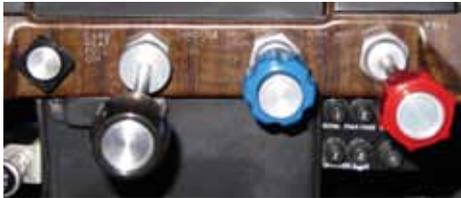
Triebwerk Bedienelemente: Leistungs-, Drehzahl-, Gemischreglung (Cessna)
