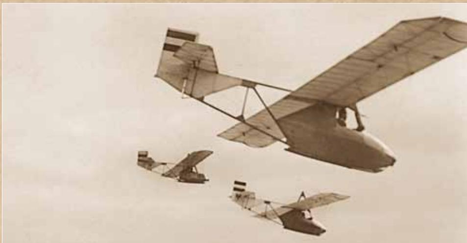
Bild 1. Flugzeugtyp mit Rumpfverkleidung
