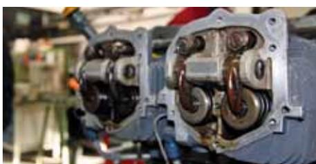
Der Gegenstand der Untersuchung, ein Kolbenflugmotor Typ Lycoming O-235 L2C, hatte zum Zeitpunkt des Schadens eine Betriebszeit von 825:00 Stunden (TSO) bei einer vom Hersteller empfohlenen maximalen Betriebszeit von 2400 Stunden (TBO). Verwendet wurde dieser Motor in einer Cessna 152, überwiegend im Einsatz als Schulflugzeug mit ca. 3-5 Minuten Platzrunden.
