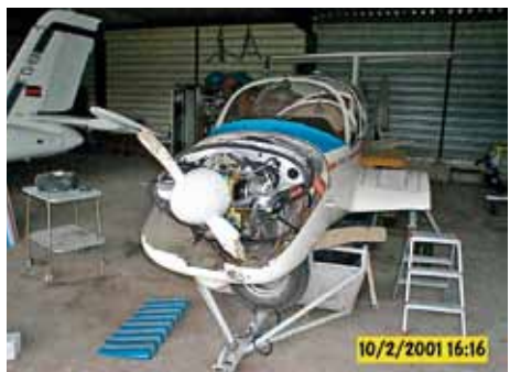
Schwer beschädigte Taifun 17 E
