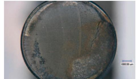
*Hochschule Karlsruhe: Bruchbild eines Bolzens – die parallel laufenden Spuren deuten auf einen Bruch durch Vibration hin.*
