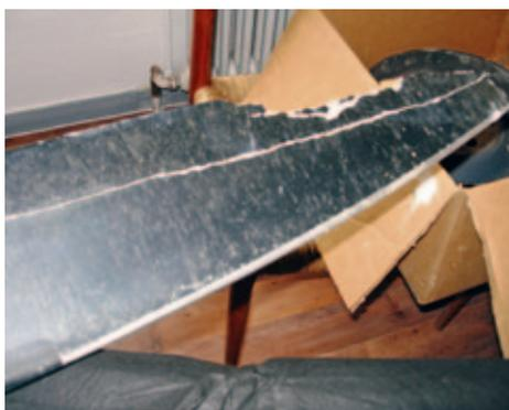
*Beschädigtes Propellerblatt. Der Längsbruch fast über das ganze Blatt lässt auf Ermüdungsbruch durch „Flattern“ schließen. Das an der Hinterseite abgebrochene Material kann durch Vogelschlag oder durch Hindernisberührung beim Aufprall entstanden sein.*
