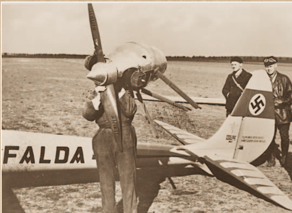
Bild 3: Segelflugzeuge mit Hilfsmotor: Ein Segelflugzeug wird motorisiert
