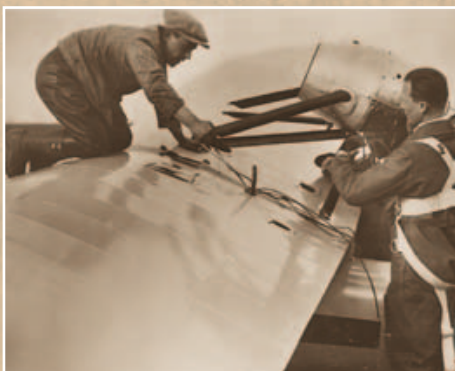
Bild 4: Segelflugzeuge mit Hilfsmotor: Einbau des Hilfsmotors
