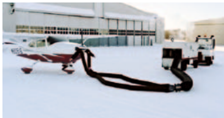
Bild 6: Minus 25 Grad Außentemperatur erfordern vor dem Start in Goose Bay eine Motoraufwärmung
