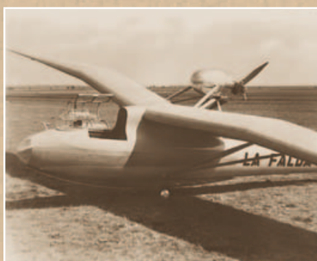
Bild 6: Segelflugzeuge mit Hilfsmotor: »La Falda«, der erste Motorsegler mit abnehmbarem Motor
