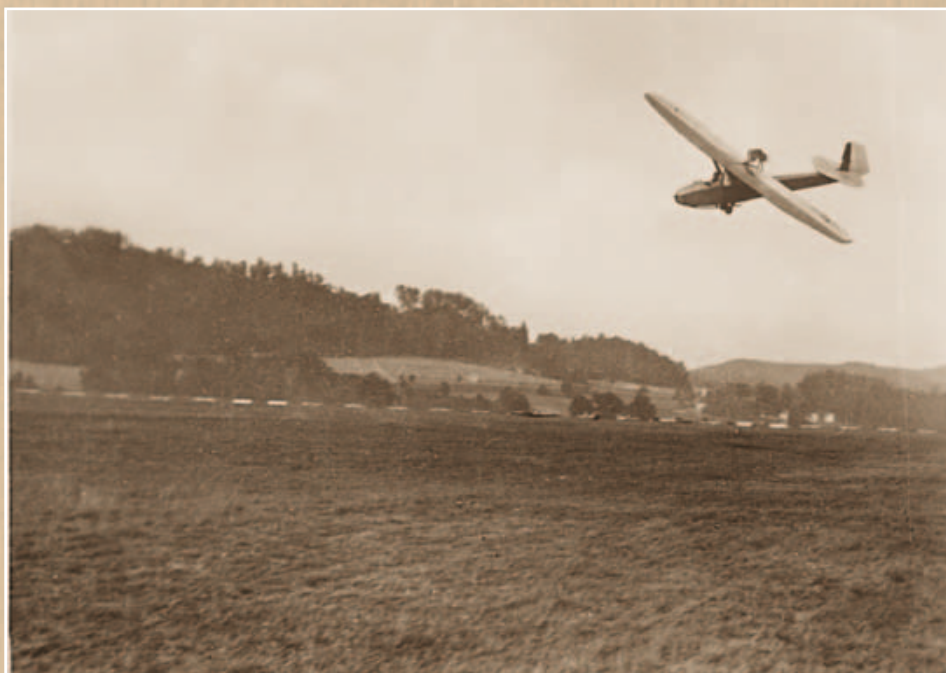
Bild 2: Segelflugzeuge mit Hilfsmotor: Versuchsbau »Motor-Baby«
