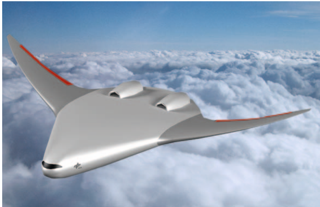
Bild 1: Modell eines vom „Deutschen Zentrum für Luft- und Raumfahrt“ (DLR) entwickelten zukünftigen „Blended Wing Body“ (BWB), zur Überprüfung der aerodynamischen Eigenschaften. Foto: DLR
