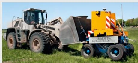
Bild 8. HWL Test – Heavy Wheel Load.
