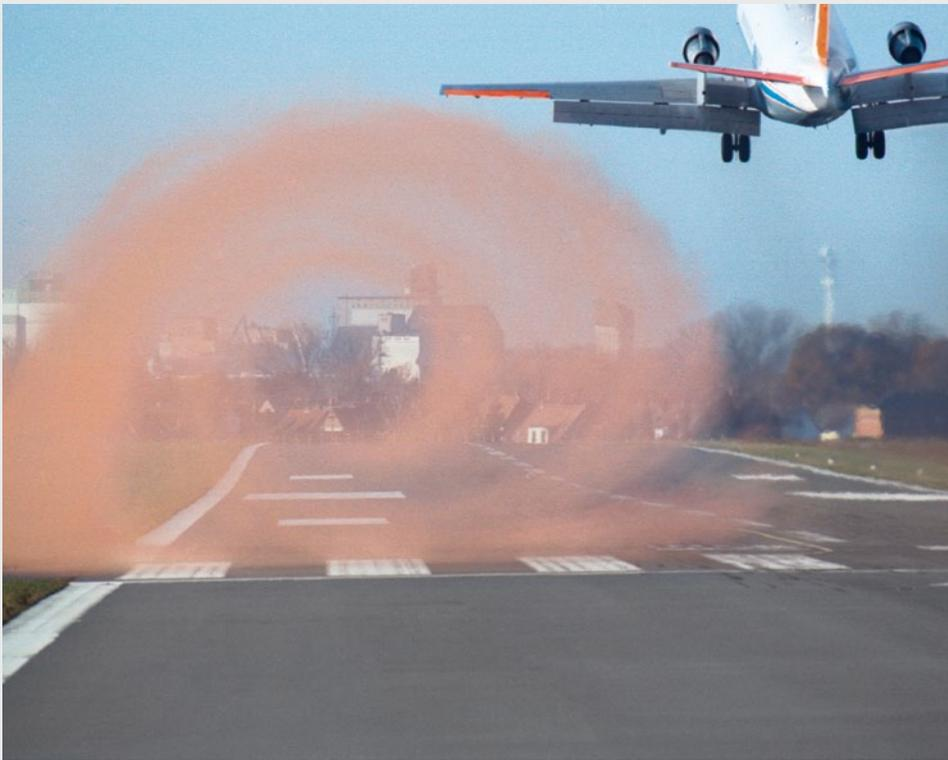
Bild 2. Flugwirbel einer startenden Maschine.
