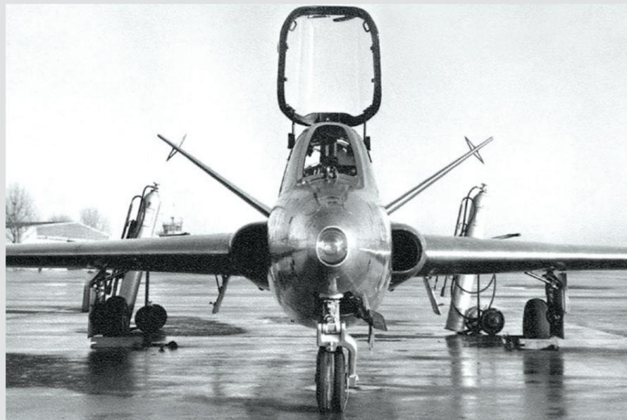
Das Luftfahrzeugmuster Fouga CM.170R Magister wurde bei der Flugzeugführerschule „A“ in Penzing eingesetzt und war für Jürgen Ave das erste Flugzeug mit Jetantrieb. Gut zu sehen ist das außergewöhnliche 110° Schmetterlingsleitwerk, Foto: Helmut Jäger.
