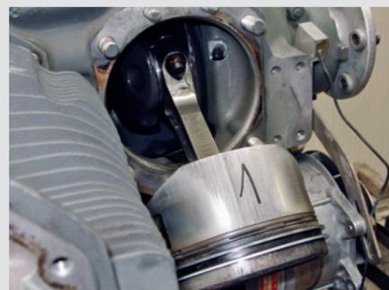
Bild 2: Laufspuren am Kolben 1 – verursacht durch Kaltstart
