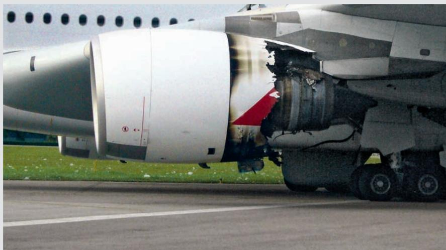
Das explodierte Triebwerk No. 2 des Qantas A380
