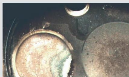
Abb. 1-3: Beispiel für die Probleme mit Zylindern, wenn die vorangegangenen Ausführungen nicht beachtet werden. Diese liegen im wesentlichen im oberen Teil der Zylinderlaufbuchse in der „Choke Area“.
