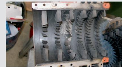
Statorgehäuse des Kompressors
