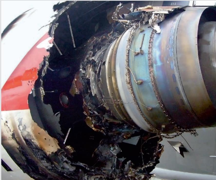
Das explodierte Triebwerk No. 2 des Qantas A380
