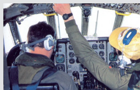
In der Nimrod sitzt der Bordtechniker um 90° gedreht hinter den beiden Piloten und überwacht u. a. die Triebwerksinstrumente. Er veranlasste den Copiloten durch einen Feueralarm im Triebwerk Nr. 2 zum Abschalten eines funktionierenden Antriebsaggregates, weil dieser sich unter Stressbedingungen in das gewohnte Cockpit einer Dominie T 1 zurück versetzt fühlte. Bild: T. Malcolm English
