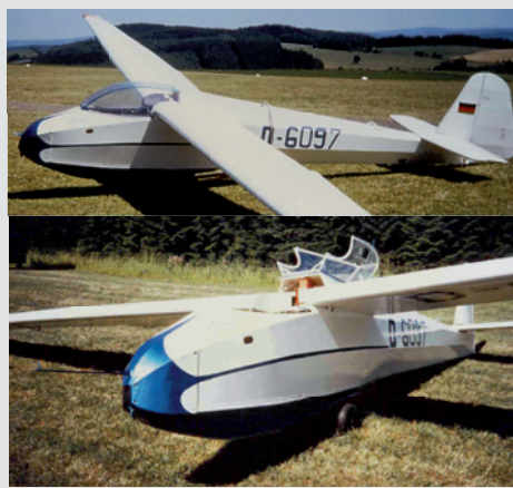
Der Konstrukteur Egon Scheibe aus Dachau hat mit Sicherheit nicht an das Habit Pattern von Segelfliegern beim Bedienen der Haube gedacht, als er Anfang der fünfziger Jahre den A-Spatz konstruierte. Bei diesem Flugzeugtyp ist der Normal- und der Notöffnungsvorgang identisch. Vom Piloten wird im Notfall keine andersartige und selten praktizierte Handlungsweise verlangt. Fotos: Harald Meyer
