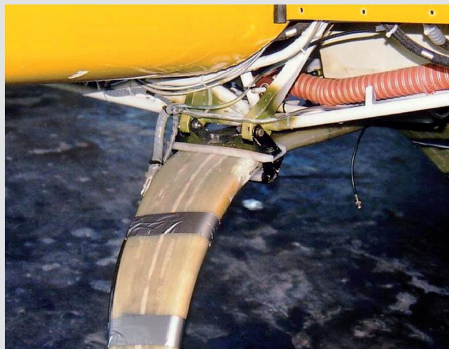
Bild 1: Befestigung des Hauptfahrwerksträgers
