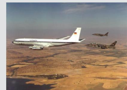
Beim Formationsflug mit einer Boeing B-707 der Flugbereitschaft des Bundesministeriums der Verteidigung müssen die Piloten der beiden Alpha Jets auf Wirbelschleppen achten und immer seitlich und leicht höher als das Flugzeug mit rund 150 Tonnen MTOM bleiben, Foto: Rainer Otter.
