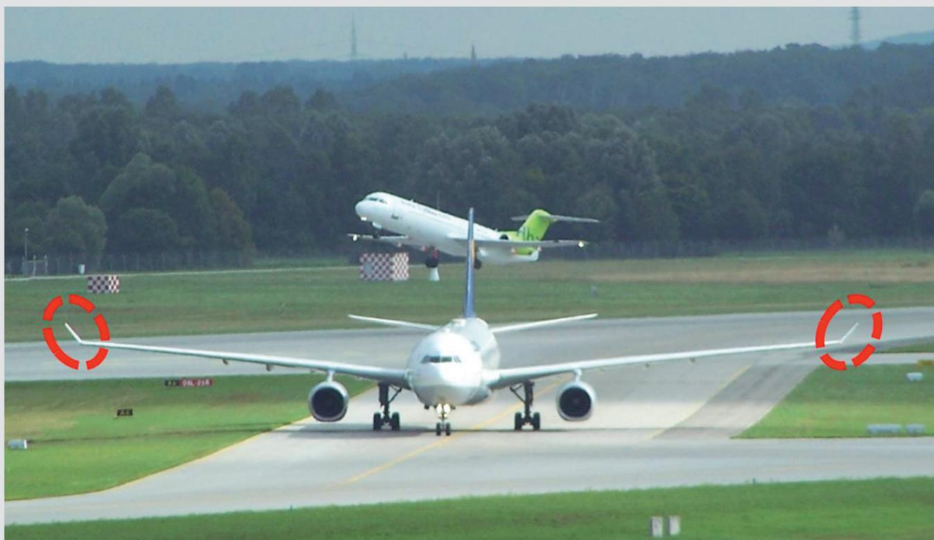
Winglets an den Flügeln reduzieren die Intensität von Randwirbeln um ein paar Prozentpunkte.
