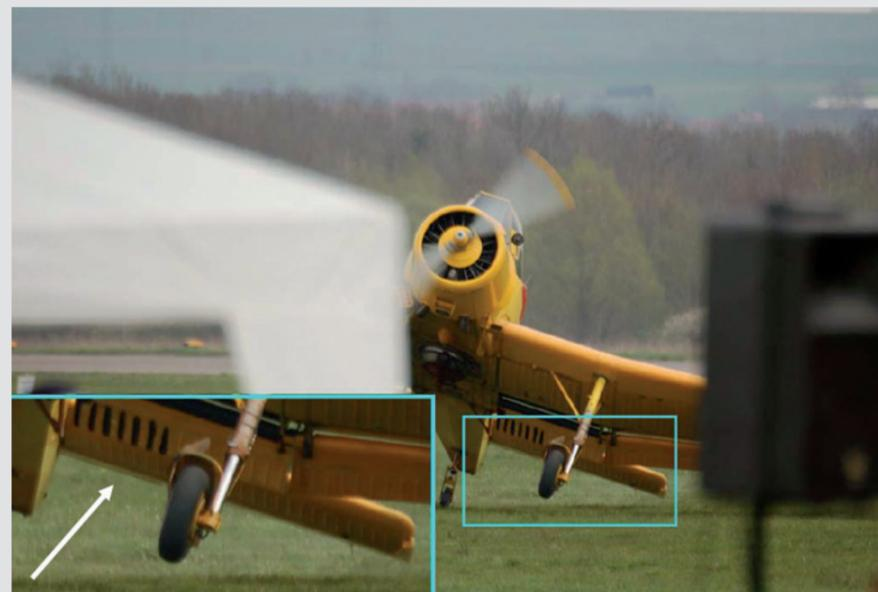
Foto: Zeuge 3 - Vergrößerung des Ausschnittes durch BFU. Das Foto zeigt in der Detailvergrößerung das gezogene Höhenruder mit nach unten ausgeschlagenem Trimmeruder (siehe Pfeil). Flugzeugabsturz am 3. Mai 2008
