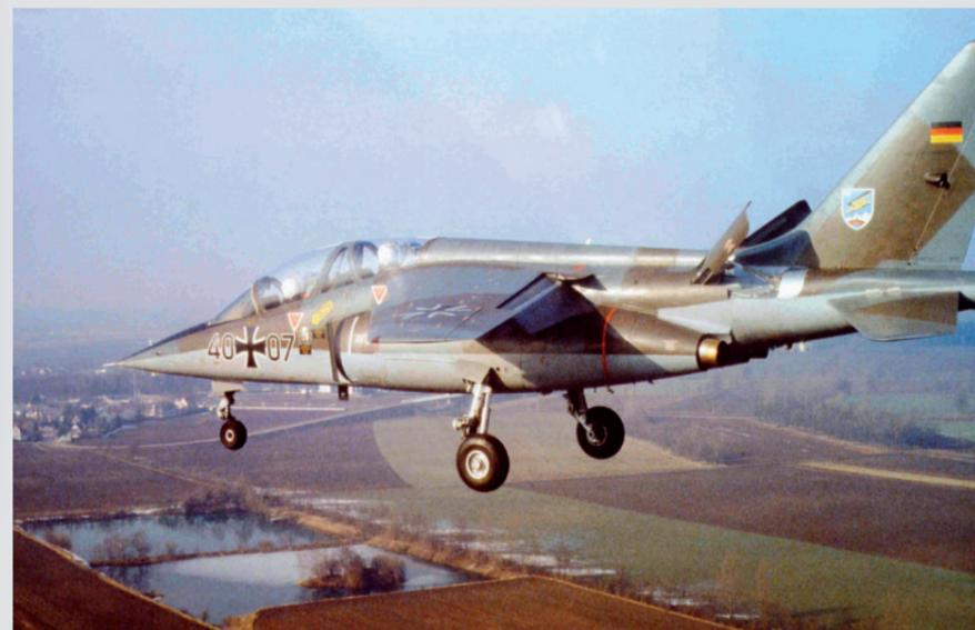
Abb.:2 Anflugkonfiguration mit Gear-down, Flaps-down und Speedbrakes-out, Foto: Harald Meyer
