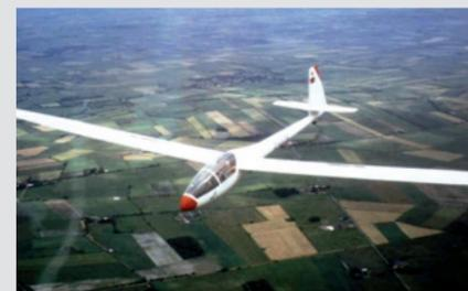
Der Autor in einem Cirrus von Schempp-Hirth. Das Segelflugzeug hat eine Spannweite von nahezu 18 Metern und weist eine Streckung von 25 auf.
