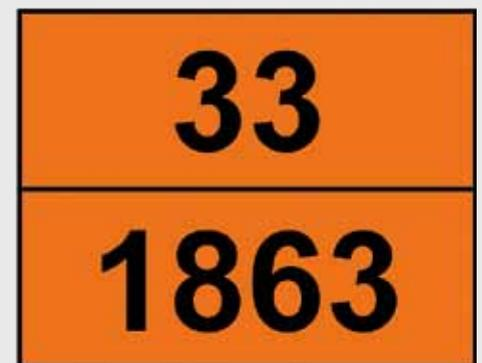
Die orange Gefahrentafel mit der Kemler-Zahl in der oberen Hälfte sowie der UN-Nummer in der unteren Hälfte. Der Code 1863 steht für Flugkraftstoff.
