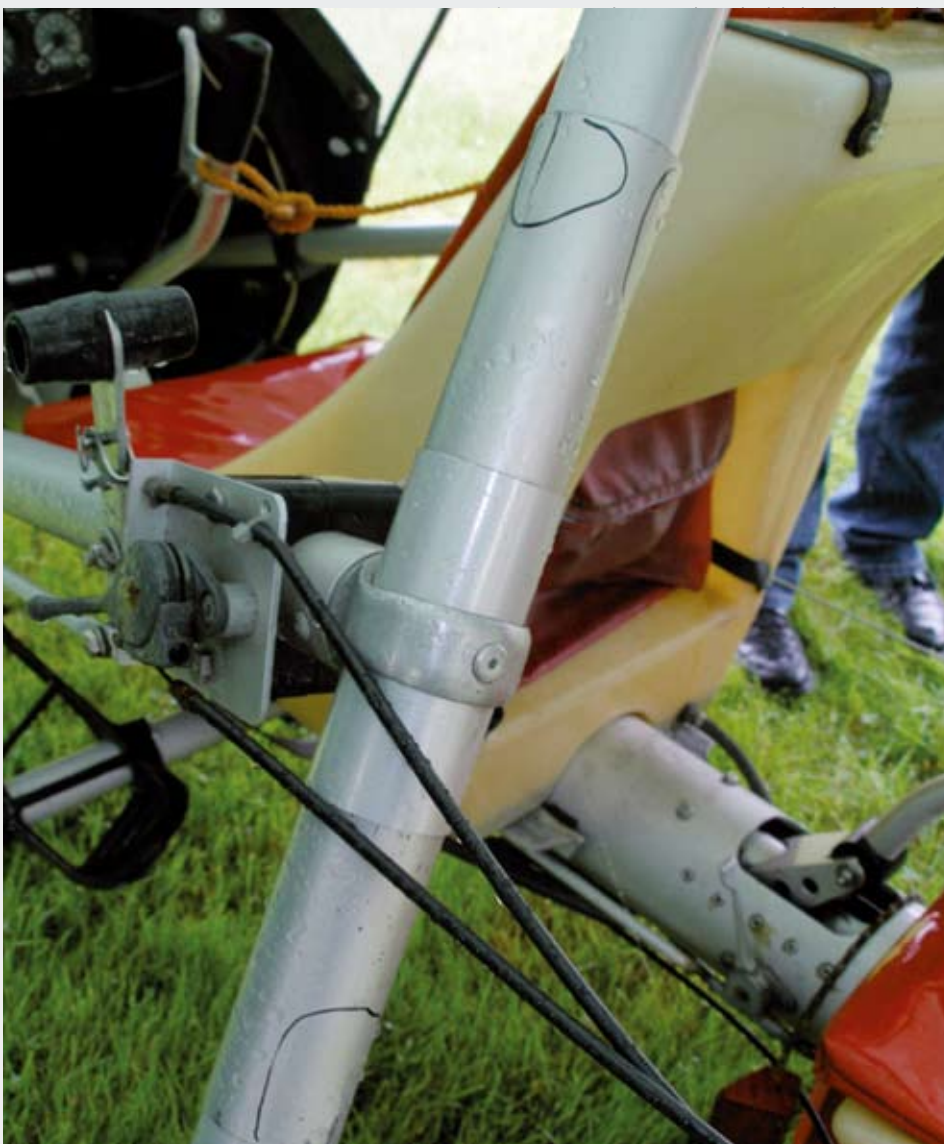
Abb.:1 Gebrochene Verstrebung und gestauchtes Rumpfrohr im Bereich des hinteren Steuerknüppels
