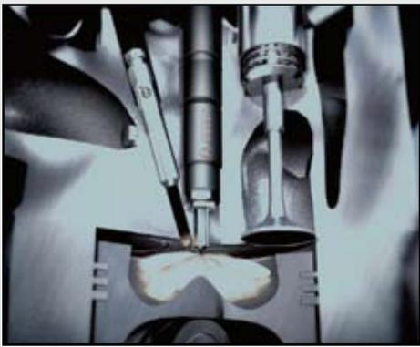
Brennraum eines Diesel-Motors mit Direkteinspritzung<sup>4</sup>
