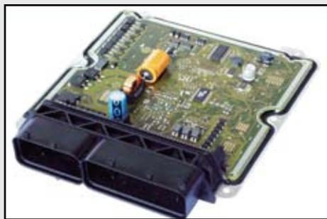
Motorsteuergerät für einen CommonRail PKW-Dieselmotor<sup>12</sup>
