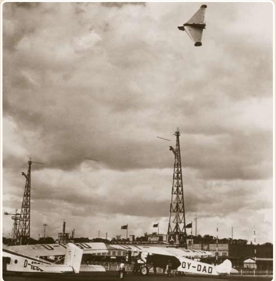
Bild 5 Schwanzloses Versuchsflugzeug „Delta“
