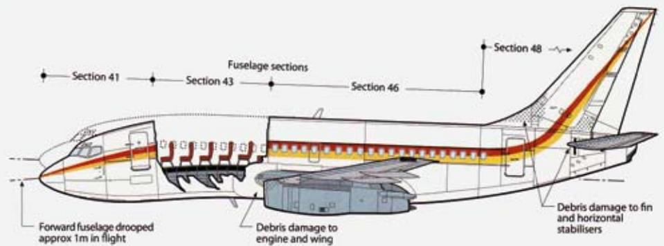
am Rumpf „kalt“ geklebt, mit Epoxid getränkten Textilstücken, entlang der Kanten der Hautbleche. Zur Verstärkung dienten drei Reihen Nieten. Damit sollten die Kräfte zwischen den Blechenden besser übertragen werden und nicht nur die Nieten belasten (siehe Abb.) Diese Klebetechnik wurde 1972 eingestellt, weil sie ein Sicherheitsrisiko darstellte. Die Untersuchung der Abrißstellen an der
