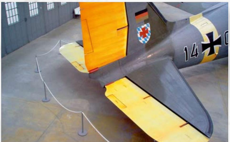
Flugzeugheck einer Skytrain mit den beiden Trimmklappen am Höhenruder mit einer Größe von 20 x 80 cm,
