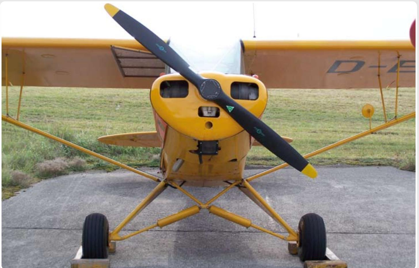
Bild 4: Noch heute sind einige Piper-Flugzeuge so lackiert wie im Luftwaffeneinsatz. Gut zu erkennen sind die Ballonreifen und der schlanke Rumpf. Angetrieben wird eine starre Zweiblatt-Luftschraube von einem 90 PS starken Vierzylinder-Boxermotor.
