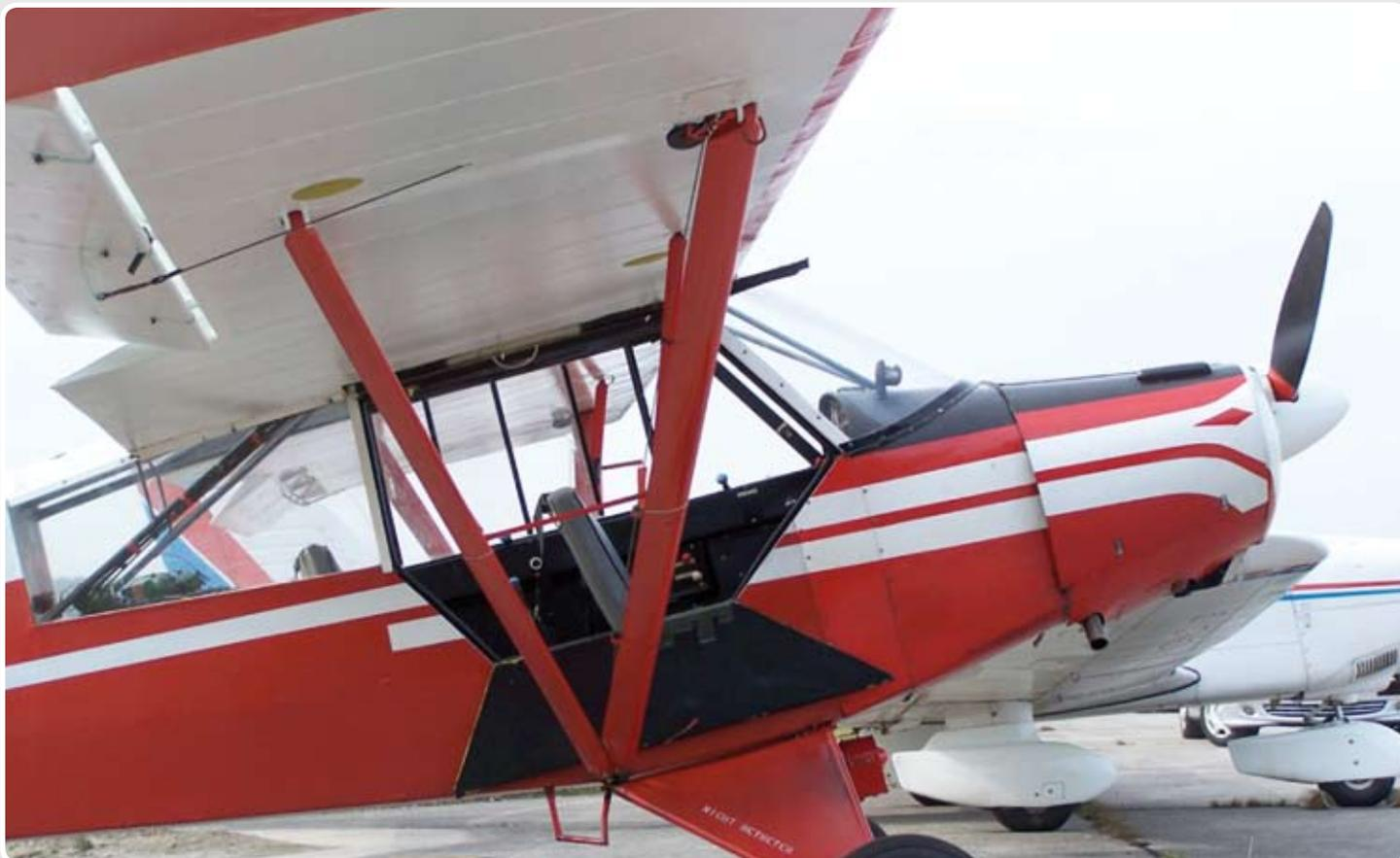
*Bild 5: Zum Einstieg für beide Plätze in Tandemanordnung wird eine Öffnung benutzt*
