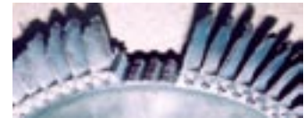
Linkes Triebwerk: Hochdruck-Turbinenscheibe. Fehlende Befestigungen und Turbinenschaufeln.
