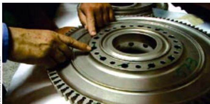
Sichergestellte JT8 Turbinenscheibe, außerhalb der Toleranzen, versandfertig (eingepackt) sichergestellt als „serviceable“.
